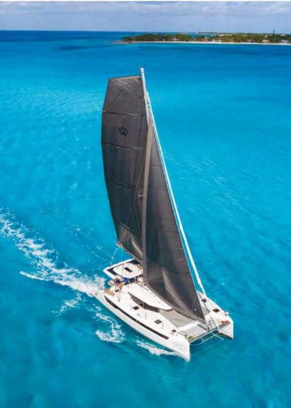
Mit einem höheren Mast und einem optionalen Hochleistungs-Aramid-Sportsegel hat er 75% mehr Segelfläche, einschließlich eines verbesserten laufenden Takelwerks für einfaches Manövrieren, das bei allen Windverhältnissen überragende Leistungen erbringt und zusammen mit dem abgestuften Rumpf für eine mühelose Steuerung auf einem gut ausbalancierten Steuerstand sorgt. Der Steuerstand ist einfach und funktionell für das Einhandsegeln ausgelegt.
