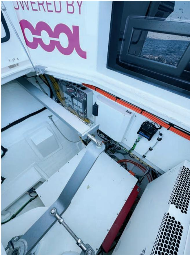
La cale moteur abrite la batterie de 27 kWh et les différents éléments du système Jool.
