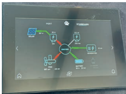
Le Leopard 52 est disponible en version hybride électrique intégrant deux moteurs en pod de 25 kW. Le tout est géré par le HMI, une interface qui indique l'état du système électrique en temps réel.
