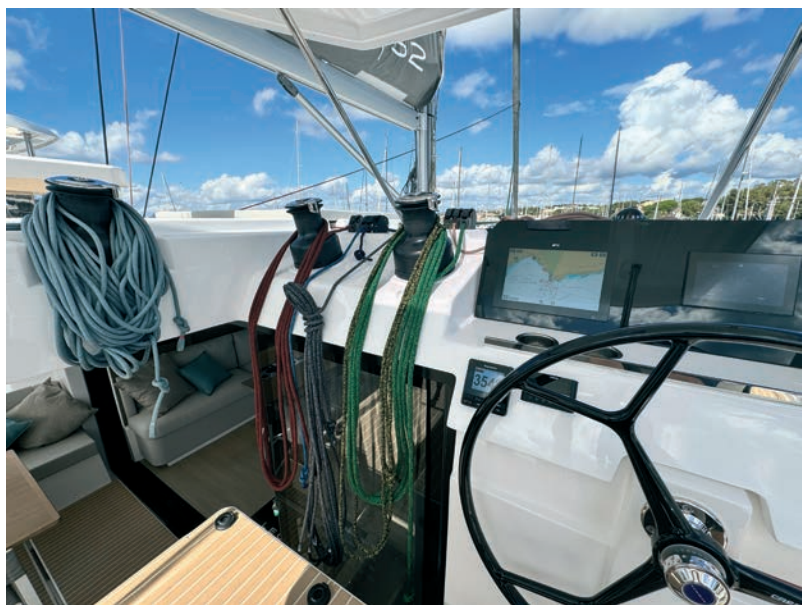
Le poste de barre a été conçu pour manœuvrer le catamaran en solo. On profite d'une bonne protection et toutes les drisses tombent facilement sous la main.
