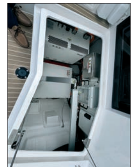
Le système de propulsion électrique est logé au même emplacement que les moteurs thermiques, et comprend deux pods de 25 kW.
