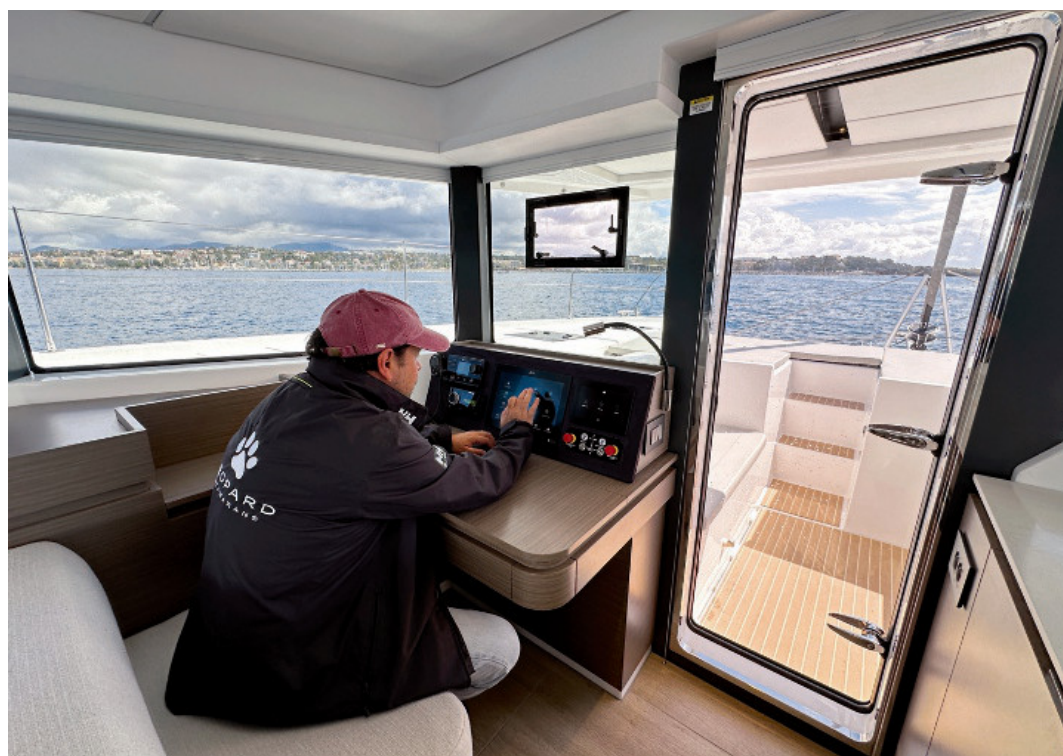
Die Navigation ist nach vorne gerichtet und bietet sich dank Rundumsicht auch als Innen-Steuerstand an. Durch eine wasserdicht verschließbare Tür gelangt man aus dem Salon direkt zum Front-Cockpit.
